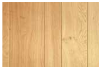
Geplankt fineer met groeven ongelijke fineerstroken
